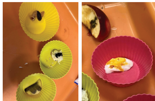
4. ábra: A keményítő kimutatása főtt tésztában, kifliben és burgonyában sikeres volt, a jódtinktúra lilás-feketés reakciót adott, míg a joghurt esetében az oldat barna színe nem változott, tehát a minta nem tartalmaz keményítőt.
