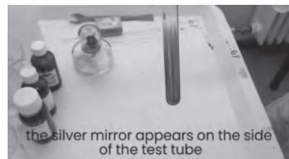
10. ábra: Redukáló cukrok kimutatása ezüstitűkőr próbával
