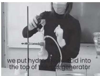
6. ábra: Hidrogén előállítása
