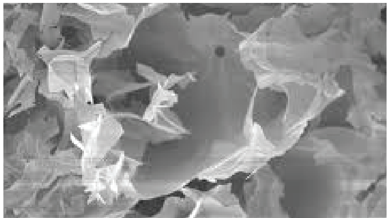
A zeolit elektronmikroszkopikus felvétele, 330-szoros nagyításban
